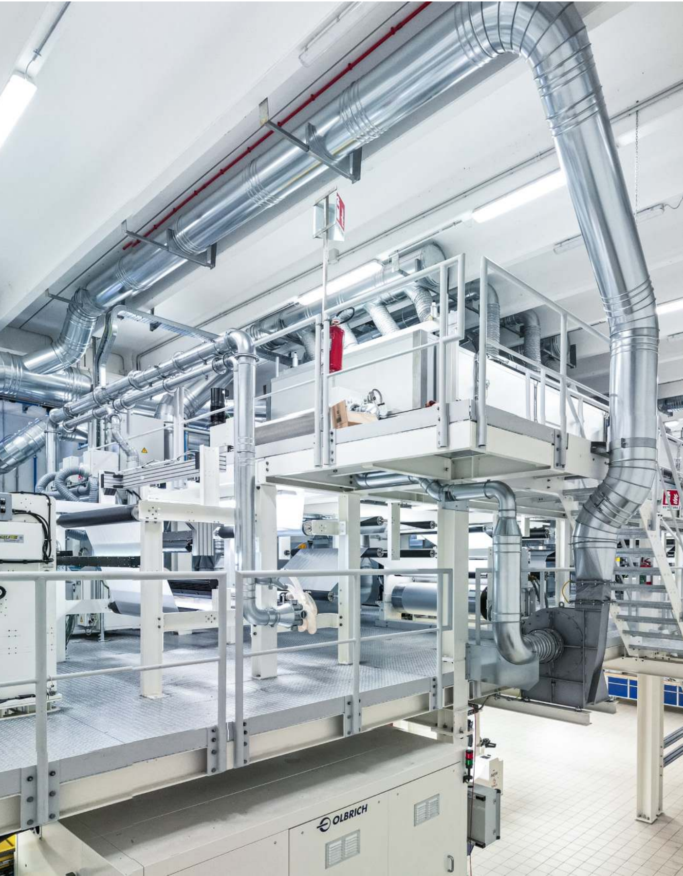
Linea produttiva di spalmatura e termostabilizzazione del film
