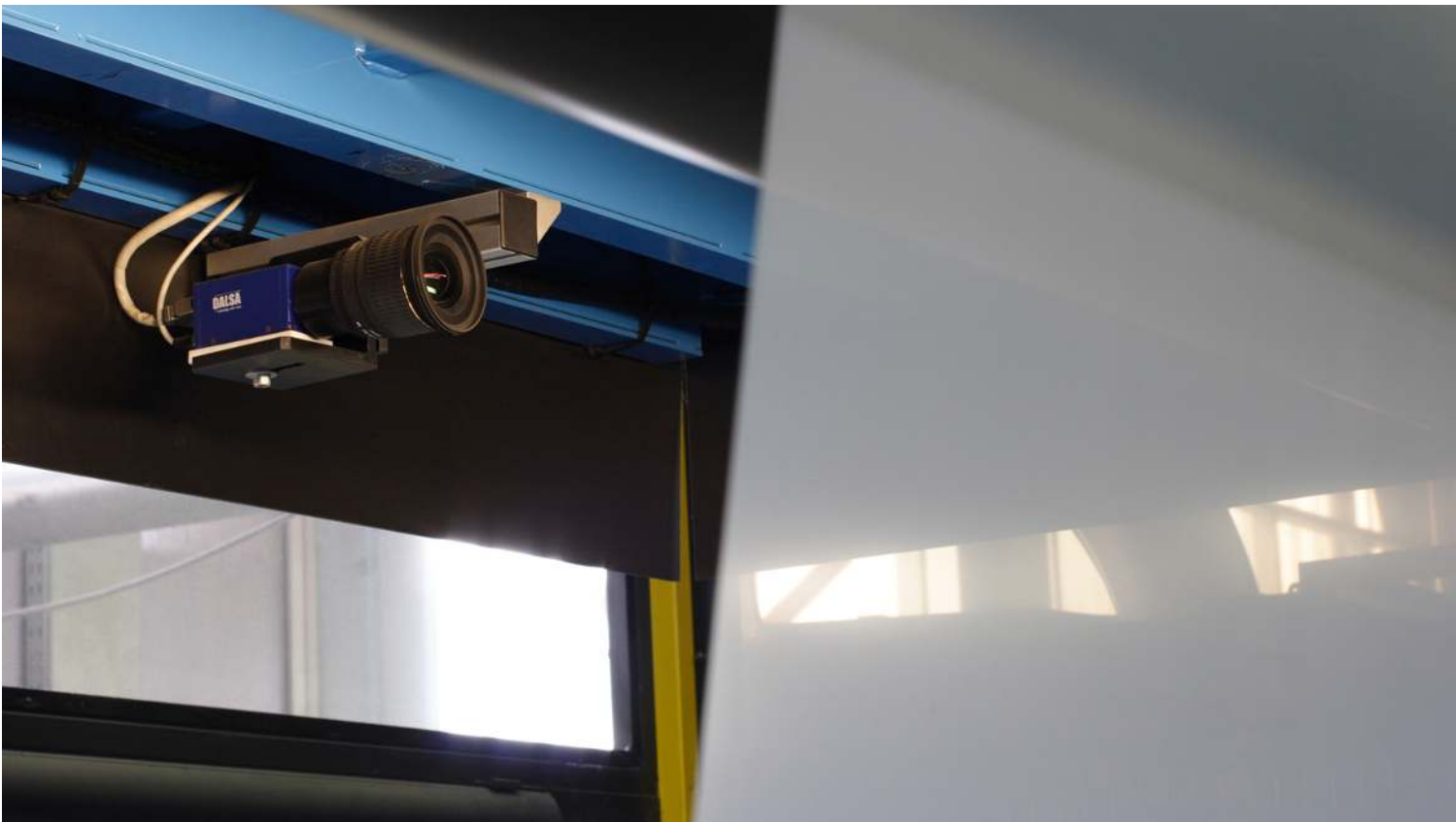
Controllo qualità in linea tramite telecamera
